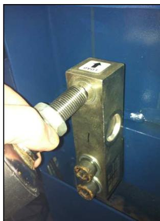
計量部を裏返して、所定の位置（4箇所）に付属の水平調節脚を取り付け、水平調節脚のナット部を回転させて、高さ調整を行ってください。
