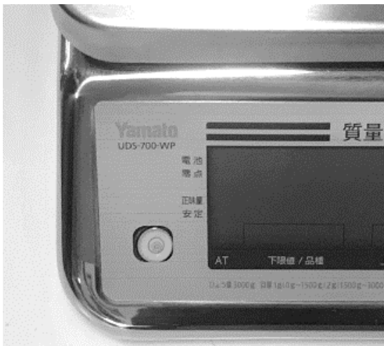
気泡の位置より、水平を確認できます。
